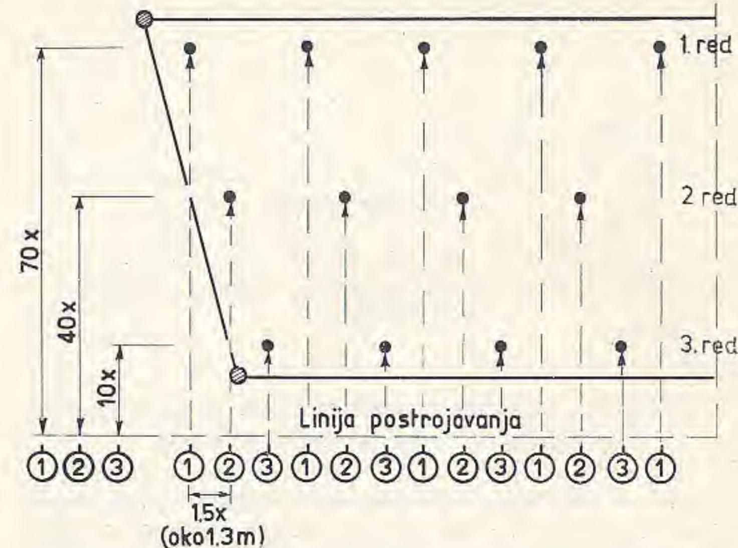
Sl. 19 — Način raspoređivanja protivtenkovskih mina strojnim rasporedom u minskom polju gustine 0,75 mina/metak — treći način
